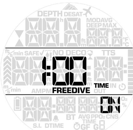
Con **TR-LP** si avvia il procedimento di impostazione degli allarmi. Prima lampeggiano le opzioni **ON** oppure **OFF**. Con **TR-SP** si possono alternare le due scelte e con **TR-LP** si conferma. Se viene confermata la scelta **ON**, il tempo di immersione lampeggia. Con **TR-SP** o **BR-SP** si può modificare il tempo di immersione e con **TR-LP** si conferma. Con **TR-LP** si esce dal menù. È possibile salvare l'impostazione e uscire dal menù in qualsiasi momento con **BR-LP**.
