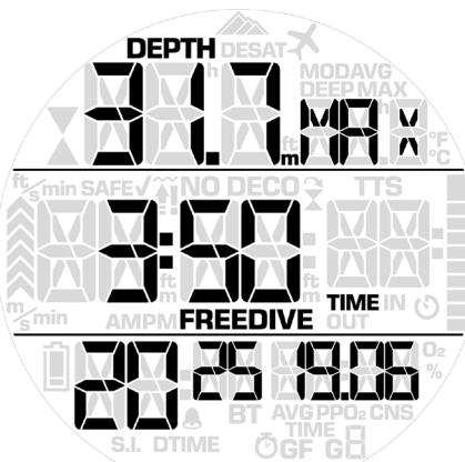
Con **TR-LP** si entra nella sessione per visualizzare la profondità massima e il conteggio sequenziale dell'immersione, il tempo di immersione, l'intervallo di superficie prima dell'immersione e la temperatura minima. Con **TR-SP** si passa al tuffo successivo della sessione.
